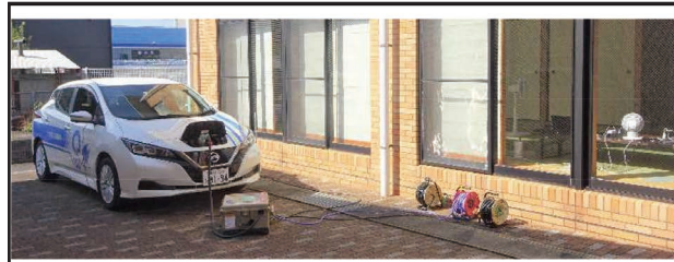
(電気自動車による緊急避難場所への給電風景)
